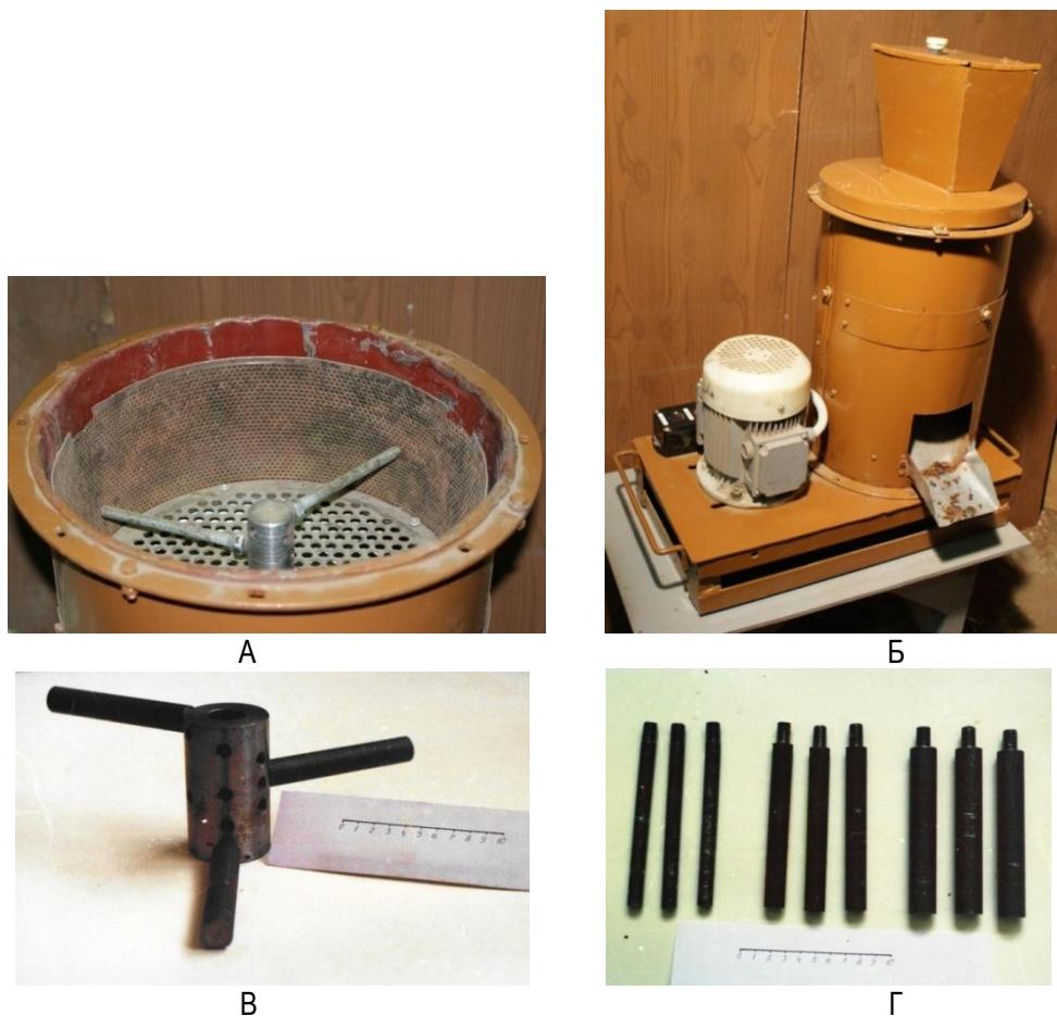
Рис. 2. Общий вид измельчителя перговых сотов: А – камера измельчения; Б – общий вид опытного образца измельчителя; В – штифтовая втулка, позволяющая изменять расстояние между плоскостями вращения штифтов; Г – штифты диаметром 10, 14, 18 мм
