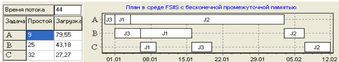
Рис. 4. Трехмашинный конвейерный FSIS-план с бесконечной промежуточной памятью
