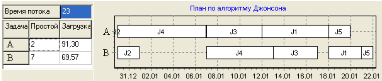
Рис. 2. Двухмашинный конвейерный план с минимальным временем потока
