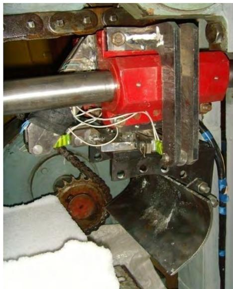
Рис. 2. Внешний вид измерительного устройства с установленной моделью отвала автогрейдера
