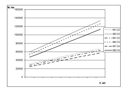
Puc. 5. График зависимости моментов, возникающих в вертикально-поперечной плоскости, от скорости движения лесопогрузчика
