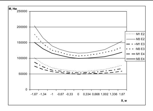
Рис. 2. График зависимости моментов M₁ и M₃ от смещения центра тяжести дерева относительно продольной оси лесопогрузчика (ель II, III, IV разрядов)
