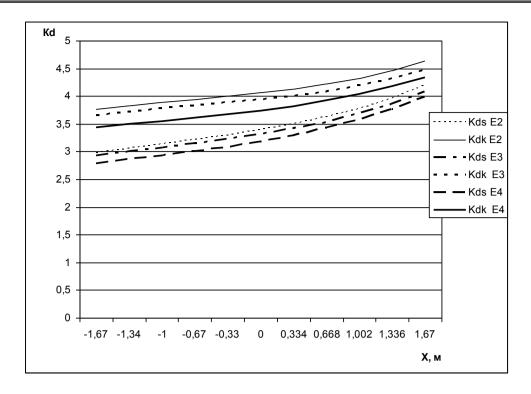
Рис. 4. График зависимости коэффициентов динамичности от смещения центра тяжести дерева в захвате относительно продольной оси лесопогрузчика (ель II, III, IV разрядов)
