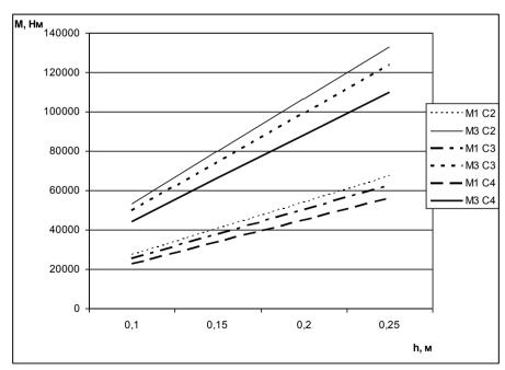
Рис. 7. График зависимости моментов, возникающих в вертикально-поперечной плоскости, от высоты препятствия
