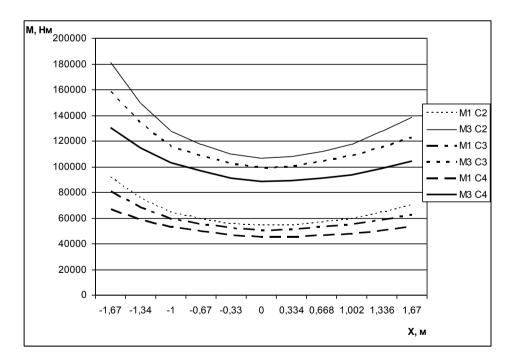
Рис. 1. График зависимости моментов  $M_1$  и  $M_3$  от смещения центра тяжести дерева относительно продольной оси лесопогрузчика (сосна II, III, IV разрядов). Здесь и далее:  $M_1$  – момент, возникающий на технологическом оборудовании;  $M_3$  – момент, возникающий на корпусе лесопогрузчика
