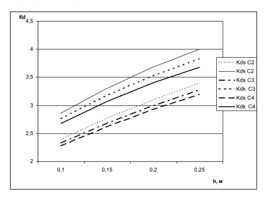
Рис. 8. График зависимости коэффициентов динамичности от высоты препятствия
