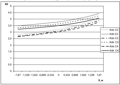
Рис. 3. График зависимости коэффициентов динамичности от смещения центра тяжести дерева в захвате относительно продольной оси лесопогрузчика (сосна II, III, IV разрядов). Здесь и далее: Kds — коэффициент динамичности технологического оборудования, Kdk — коэффициент динамичности трактора
