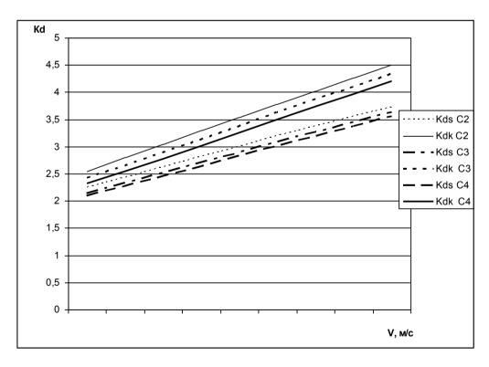
Рис. 6. График зависимости коэффициентов динамичности от скорости движения лесопогрузчика
