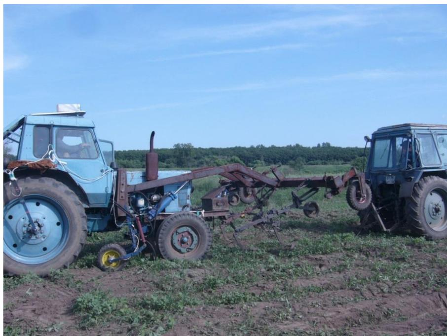
*Рис. 2. Фрагмент тяговых испытаний комбинированного МТА*
