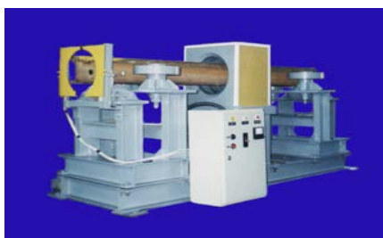
Рис. 1. Установка УРР для размагничивания рельсов в рельсосварочном производстве
