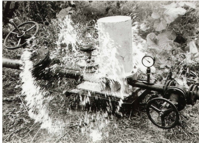
Рис. 5. Вид работы изготовленного гидротарана
