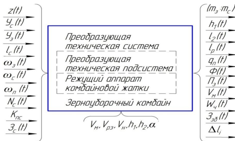
Рис. 5. Информационная модель технологического процесса преобразующей технической системы «зерноуборочный комбайн» с двойным срезом стеблей зерновых колосовых культур
