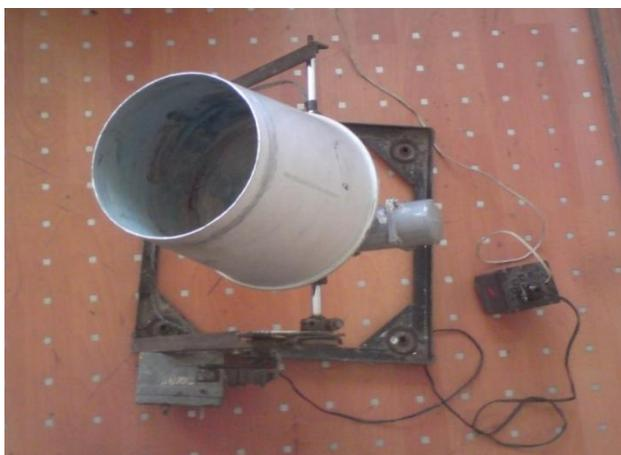
*Рис. 1. Электромеханический дражиратор*
