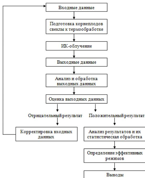
Рис. 6. Алгоритм проведения экспериментальных исследований по определению эффективных режимов ИК-энергоподвода
