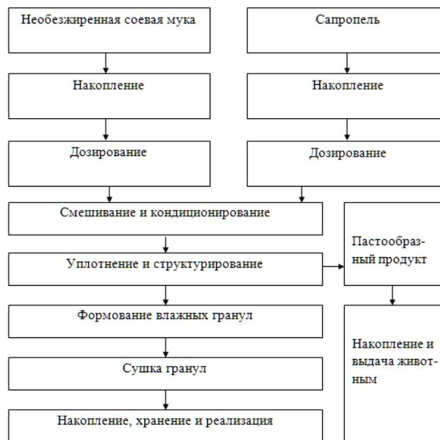
Рис. 2. Технологическая схема приготовления соево-сапропелевой белково-минеральной кормовой добавки в виде гранулята и пасты
