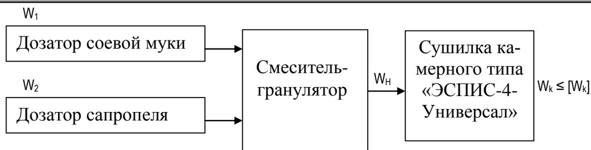
Рис. 1. Структурная схема линии получения белково-минерального гранулята
