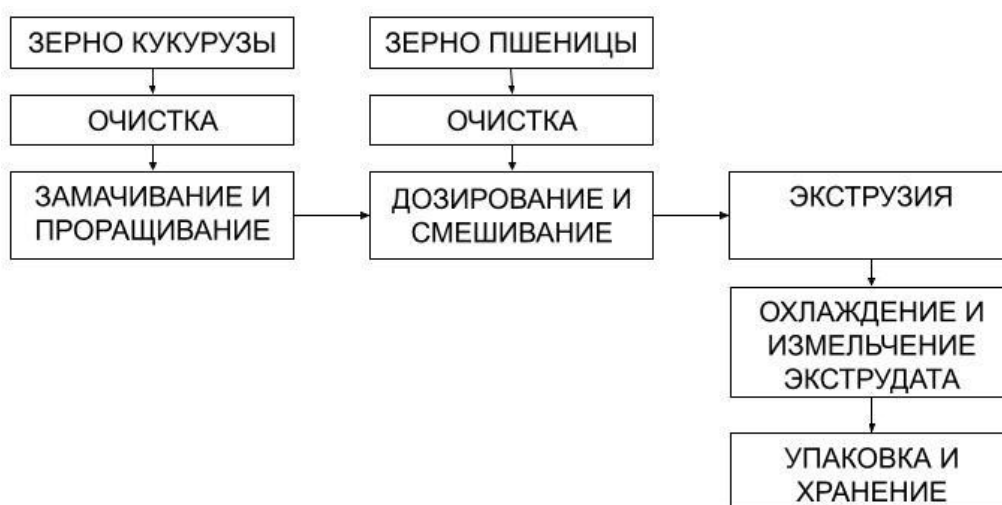
Рис. 1. Схема технологического процесса производства текстурированной муки с предварительным проращиванием зерна кукурузы
