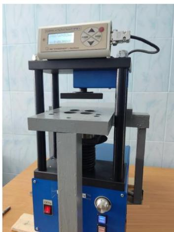
Рис. 1. Экспериментальная установка на базе пресса ПМ-МГ4
