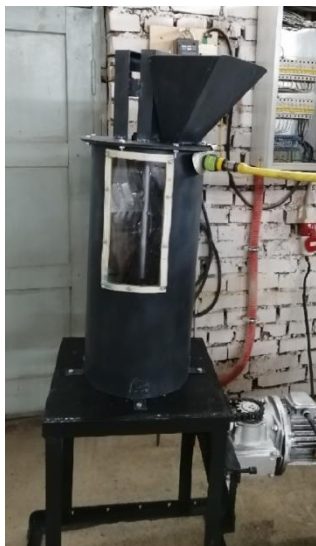
Рис. 2. Общий вид лабораторной установки для исследования процессов увлажнения и отволаживания зерна
