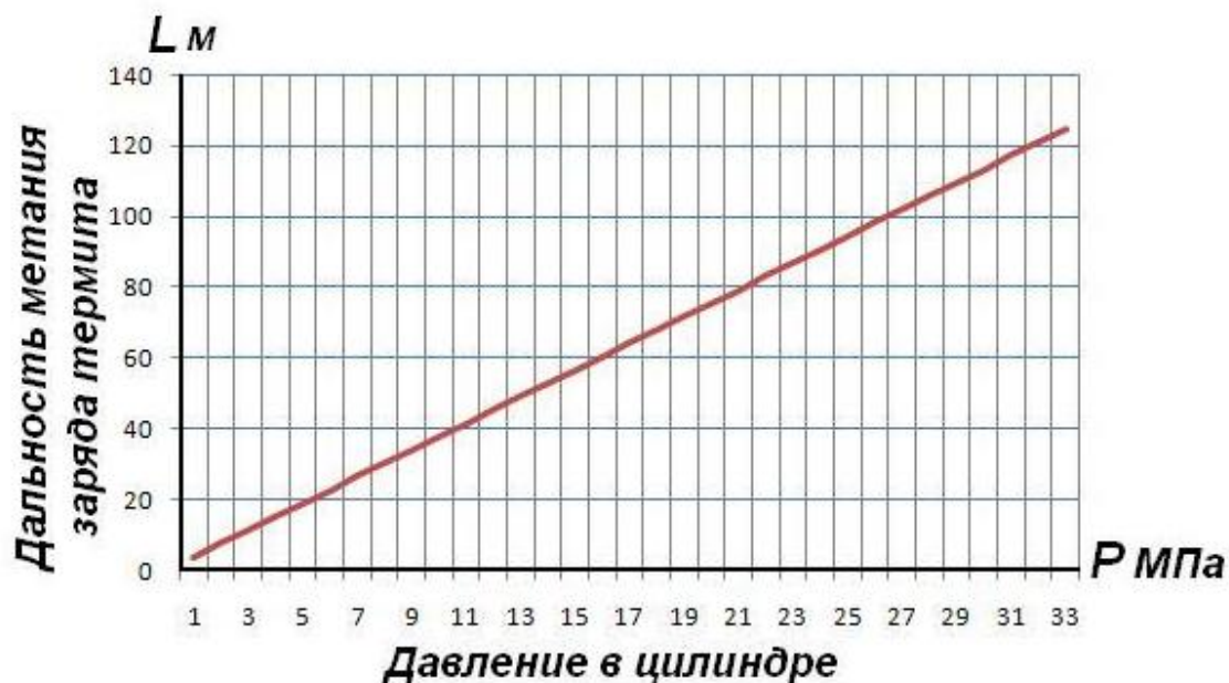
Рис. 2. Номограмма расчёта дальности метания термитного заряда массой 425 кг в зависимости от давления в цилиндрах установки
