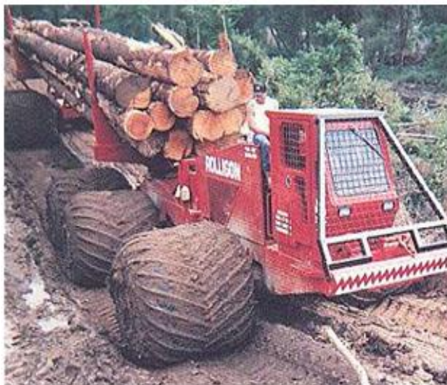
Рис. 1. Машина Challenger на пневмокатках Rolligon 72x68-28 при трелевке хлыстов
