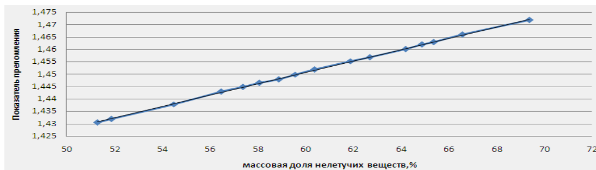
Рис. 1. График зависимости показателя преломления от массовой доли нелетучих веществ смолы
