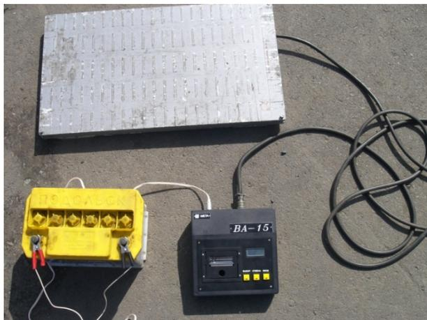
Рис. 3. Весы для определения нагрузки, действующей на колесо
