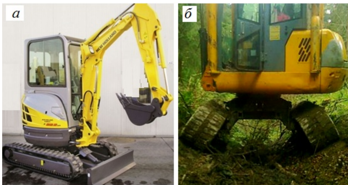
Рис. 1. Гусеничный экскаватор: а – общий вид экскаватора, б – лесомелиоративная модификация экскаватора
