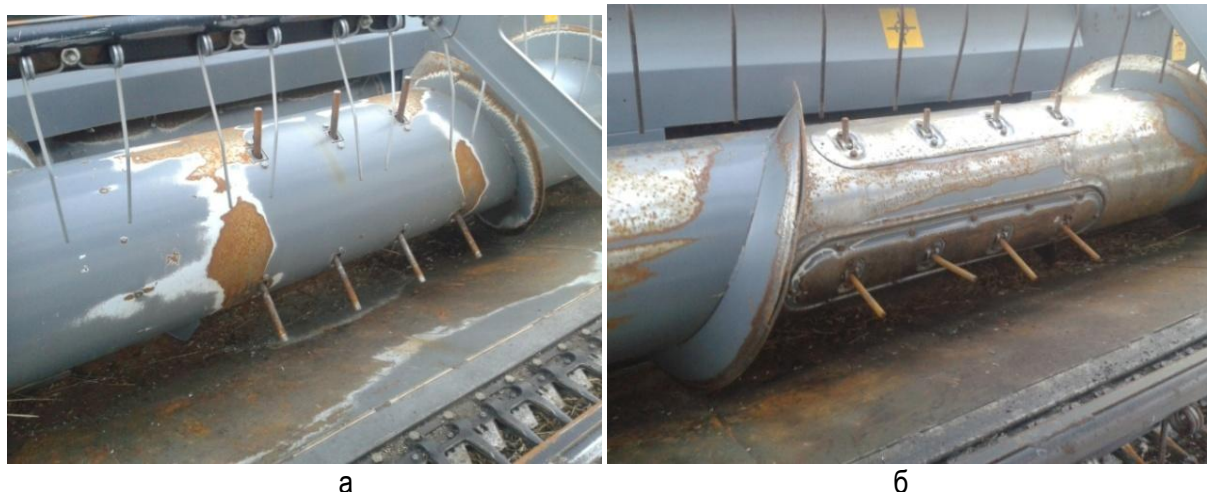
Рис. 1. Истертая поверхность днища жаток зерноуборочных комбайнов: а – комбайн Вектор 410 (1 сезон); б – комбайн Вектор 410 (2 сезона)
