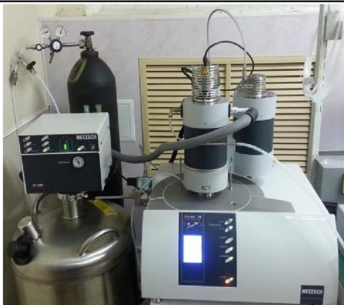
Рис. 1. Прибор синхронного термического анализа (TG-DTA/DSC) модели STA 449 F3 Jupiter
