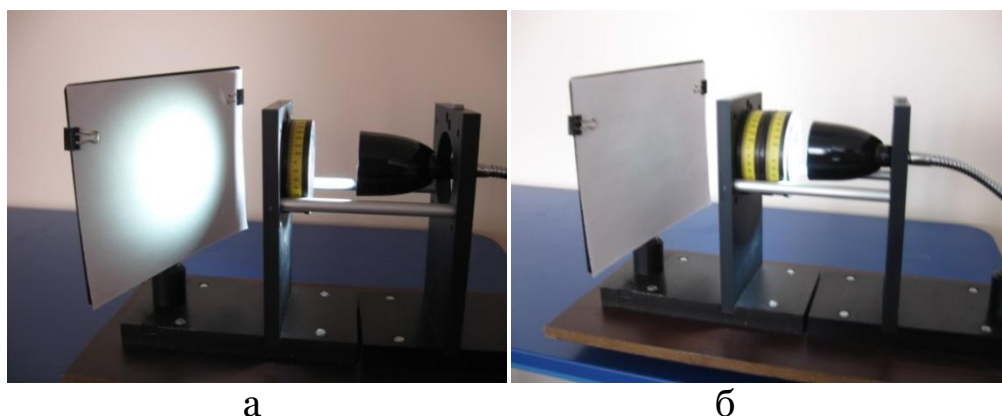
Рис. 2. Установка для наблюдения поляризации света: а – поляризация света светодиодной лампы поляризатором; б – второй поляризатор установлен перпендикулярно первому – поляризованный свет не проходит через систему поляризаторов
