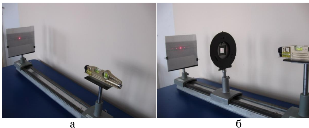
Рис. 1. Установка для наблюдения дифракции света
