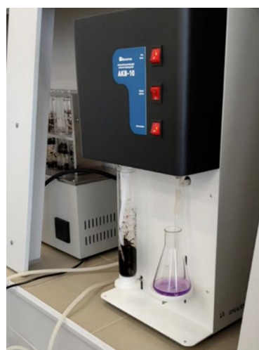
Рис. 3. Определение общего азота методом Кьельдаля Determination of total nitrogen by the Kjeldahl method
