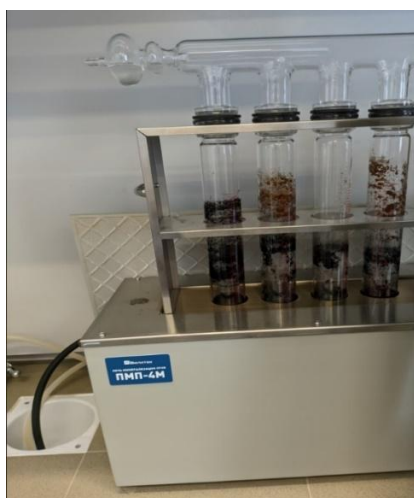
Рис. 3. Определение общего азота методом Кьельдаля Determination of total nitrogen by the Kjeldahl method
