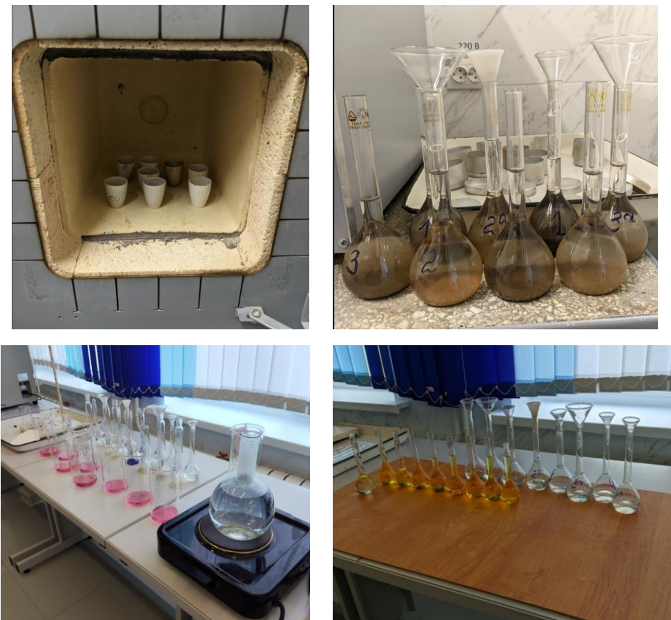
Рис. 4. Определение массовой доли кальция и фосфора Determination of the mass fraction of calcium and phosphorus
